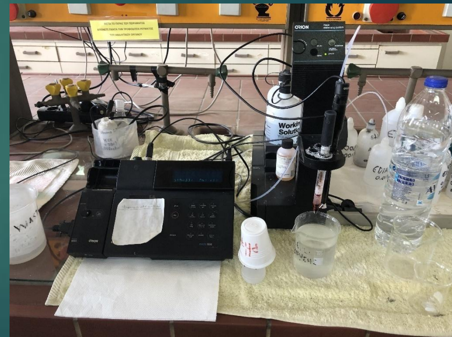
Εικόνα 14. Πειραματική διάταξη αυτόματου τιτλοδότη Orion
