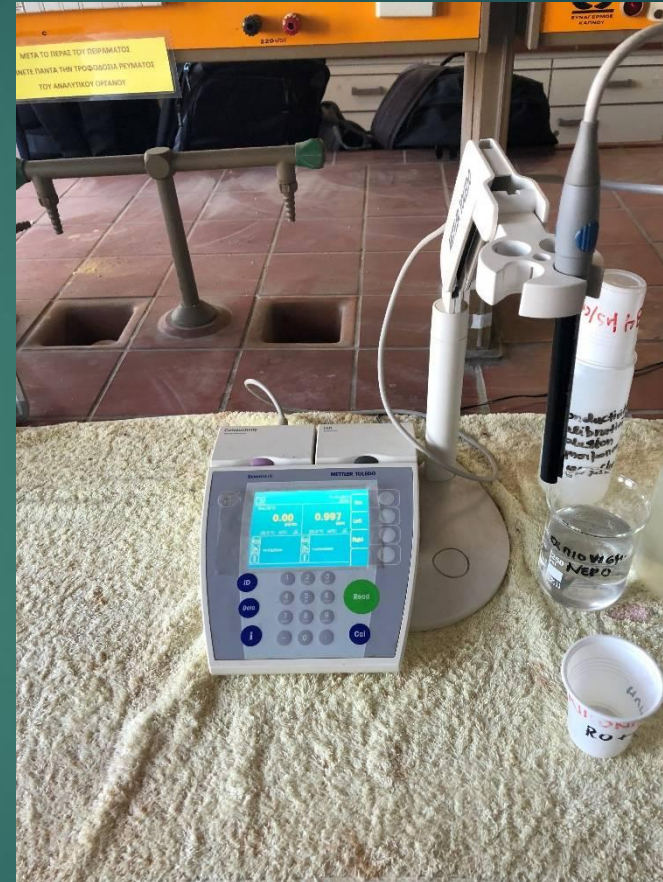
Εικόνα 4. Πειραματική διάταξη ιοντόμετρου
